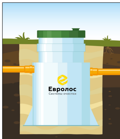
«Евролос ПРО» с удлиненной горловиной — используется при выходе коллектора из здания на глубине до 1,2 м по низу трубы.
